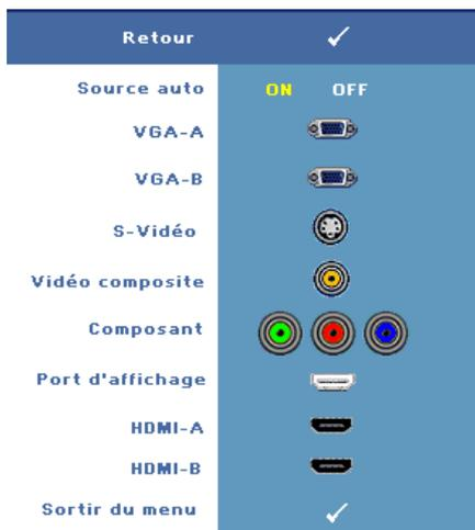
**SOURCE AUTO**—Sélectionnez **On** (le réglage par défaut) pour détecter automatiquement les signaux d'entrée disponibles. Quand le projecteur est allumé et que vous appuyez sur le bouton **Source**, il trouve automatiquement le signal d'entrée disponible suivant. Sélectionnez **Off** pour verrouiller le signal d'entrée actuel. Si vous appuyez sur le bouton **Source** lorsque le mode **Source auto** est réglé sur **Off**, vous pouvez sélectionner manuellement le signal d'entrée.
